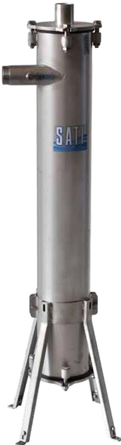
Per le loro caratteristiche costruttive i filtri **VORTEX** sono indicati per applicazioni di tipo industriale. Il corpo è in acciaio inox AISI 304 o AISI 316 e viene sottoposto ad un ciclo di decapaggio in modo da migliorarne le caratteristiche fisiche.
